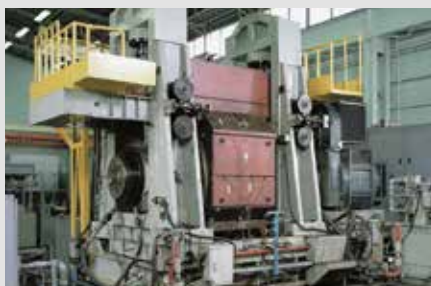
Banc d'essai pour les roulements des rouleaux d'appui de laminoirs
