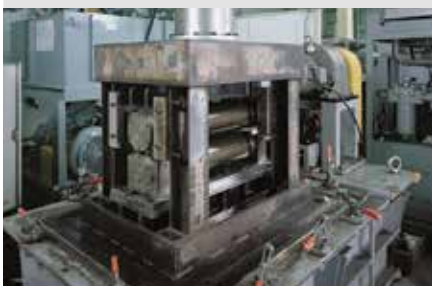
Banc d'essai pour les roulements des rouleaux de guidage de machines de coulée continue
