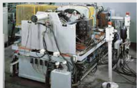
Banc d'essai pour les roulements de rouleaux de travail de laminoirs
